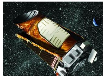
Представление художника о космическом аппарате «Кеплер», который представляет собой телескоп с диаметром 0,95-м, снабженный сверхчувствительным фотометром.
